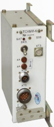
Контроллер системы, предназначен для приёма и обработки информации от приемника, а также для управления цепью подачи напряжения на электропневматический клапан.
