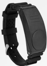
Smart-браслет – телеметрический датчик, который располагается на запястье машиниста, предназначен для получения информации об относительном изменении электрического сопротивления кожи и передачи её по радиоканалу в цифровом виде на приёмник.
